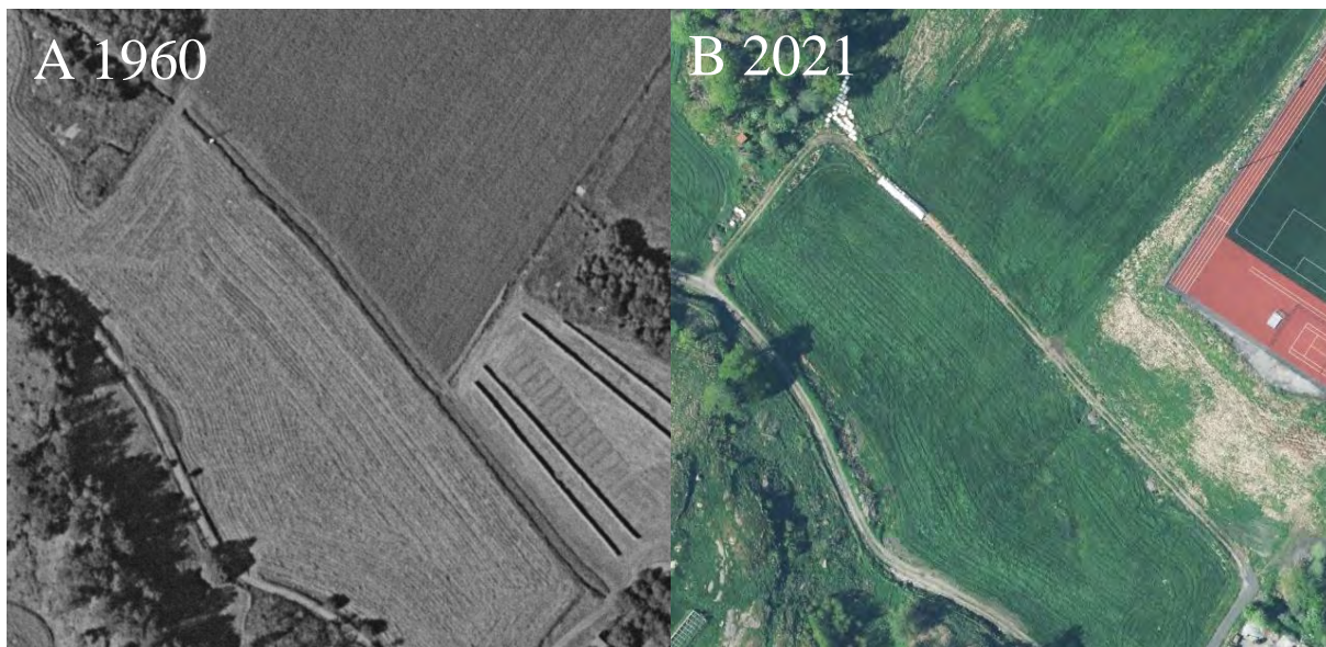
Figur 8. Gradvise endringer i segment 3. A: Utrettet og kanalisert bekk før den ble rørlagt. B: Samme parti, slik det ser ut i dag, etter å ha blitt lagt i rør.
