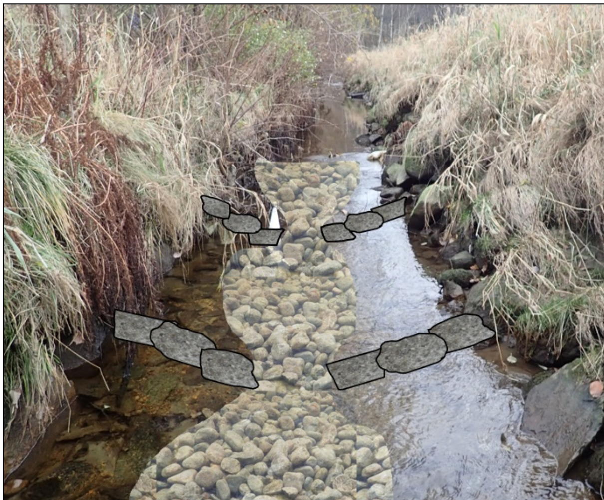
Figur 10.11. Skjematiske illustrasjon av nederste grusutlegg i Lintjørnbekken (tiltak nr. 1 i tabell 10.5 ). To små brekk etableres med stein, og grus legges ovenfor, mellom og nedenfor brekkene.
