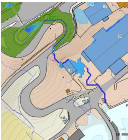
Figur 7 Utklipp fra Scalgo Live, hvor avrenningsvei fra utløpet viser. Her ser vi tydelig utfordring ved #18
