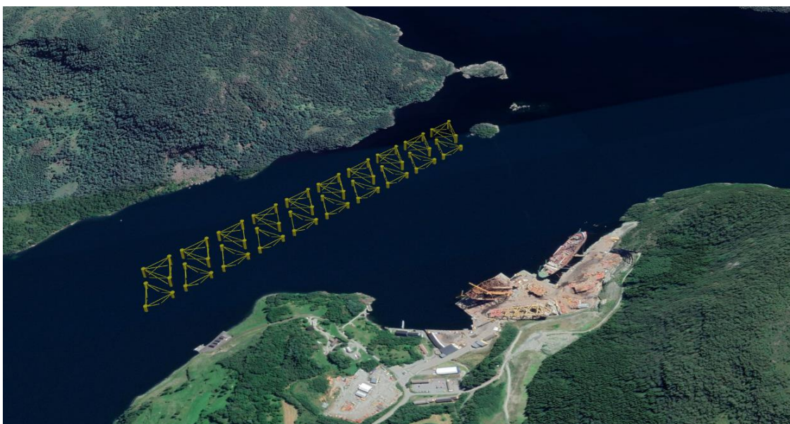
Figur 10 Illustrasjon over prinsipp for lagring av fundamenter i Vatsfjorden. Lagringen vil hensynte farleden i fjorden.
