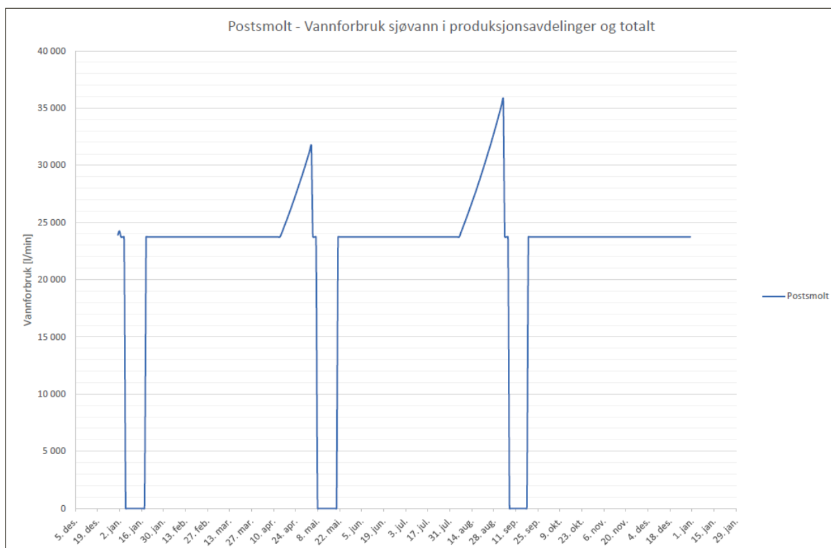
Figur 19. Oversikt over forventet sjøvannsforbruk gjennom året basert på tre innsett av fisk. Fra Artec Aqua AS.
