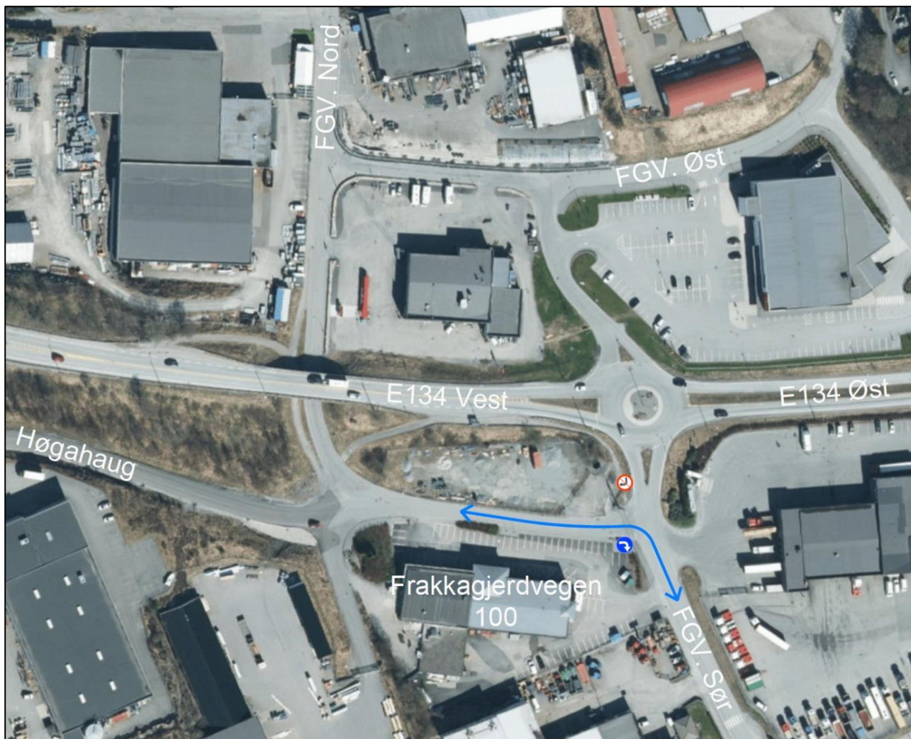
Figur 3-7: Oversikt over alternativ 4. Venstresving mot rundkjøring i enden av veg nord for Frakkagjerdvegen 100 og høyresving fra rundkjøring er forbudt. Figuren er utarbeidet av Norconsult. Ortofoto fra gislink.no.
