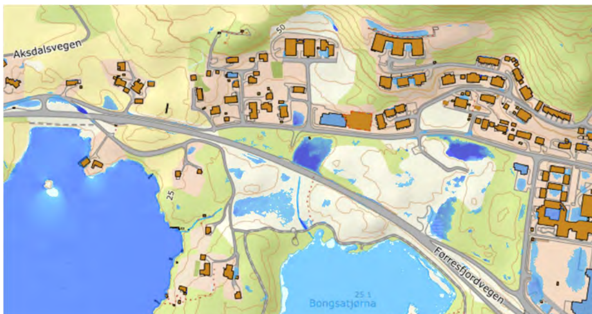
Figur 2: Blå områder viser forsenkninger i terrenget hvor det kan samle seg vann (Scalگو Live, 2021). Kartet kan fungere som et aktsomhetskart for overvannsfloam.
