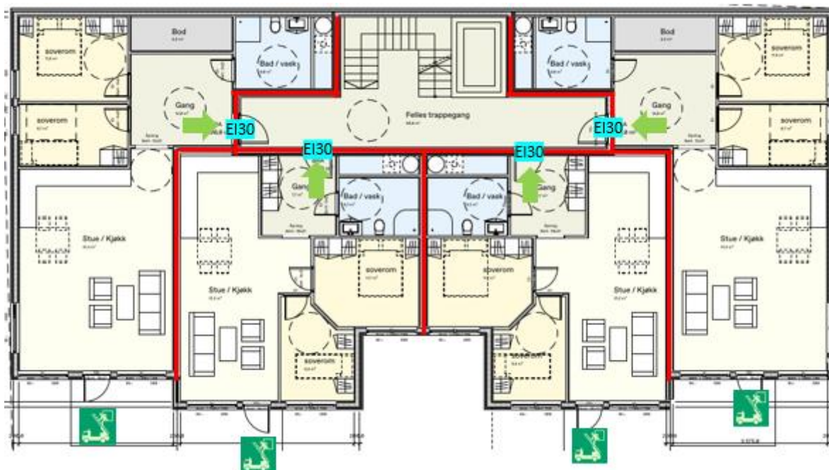
Figur 3-1: Typisk plan – inndeling i brannceller, rømning/tilrettelegging for stigebil
